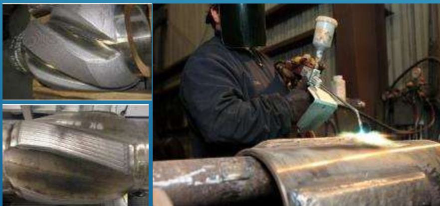
Reparación de Moledores Junk Mills, Rotary Shoes, con y sin insertos.
